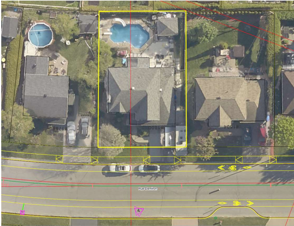
Empiètement du trottoir : 1,3m
